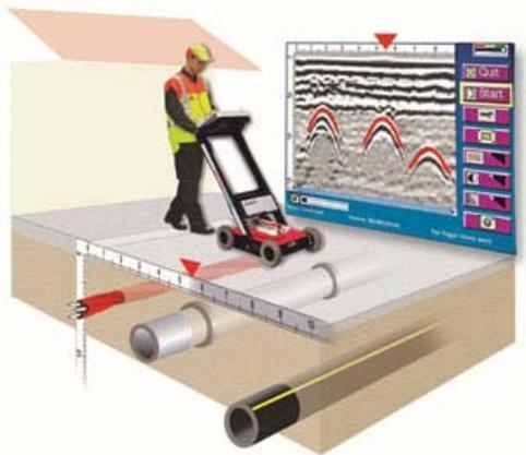
L'antenna viene fatta scorrere lungo una o più linee di indagine, secondo una griglia stabilita, in modo che i segnali possano successivamente essere associati alla posizione reale da cui sono stati emessi e ricevuti.
