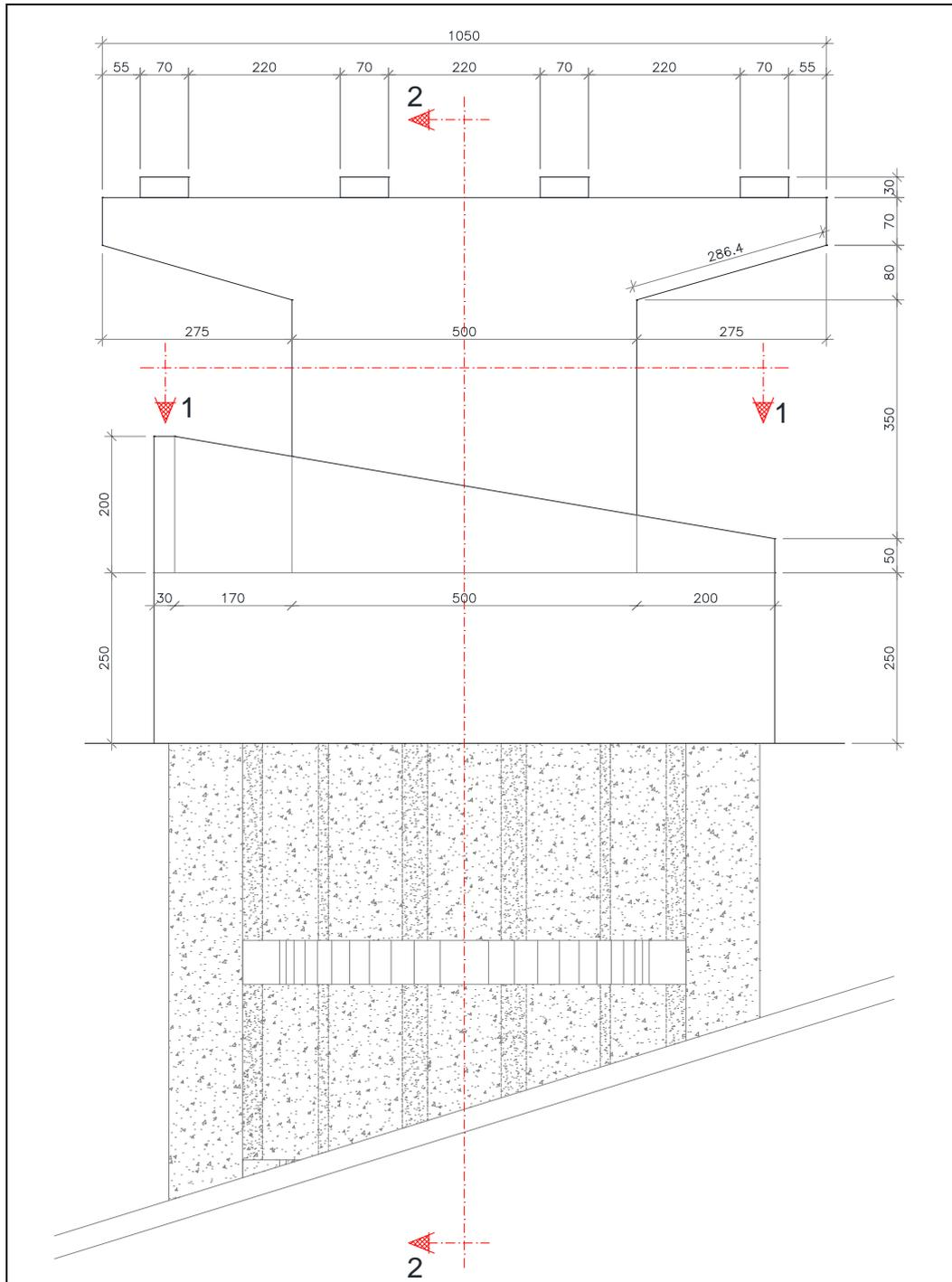
La pila centrale, in pianta presenta sezione rettangolare 500 x 300 cm, spessore delle pareti 50 cm, H= 400 cm + pulvino H= 150 cm per un totale di 550 cm. Il pulvino è rastremato alle estremità, con una altezza finale di soli 70 cm.
