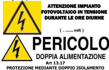
Tra impianto di messa a terra e dispositivi di protezione attiva, la protezione contro i contatti diretti può essere realizzata adottando macchine o apparecchi con isolamento doppio o rinforzato per costruzioni o installazioni: apparecchi di classe II.
