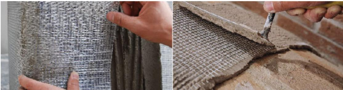
Il tessuto in fibra di acciaio galvanizzato ad altissima resistenza è un tessuto unidirezionale formato da micro-trefoli di acciaio ad altissima resistenza galvanizzati, fissati su una microrete in fibra di vetro che ne facilita le fasi d'installazione.
